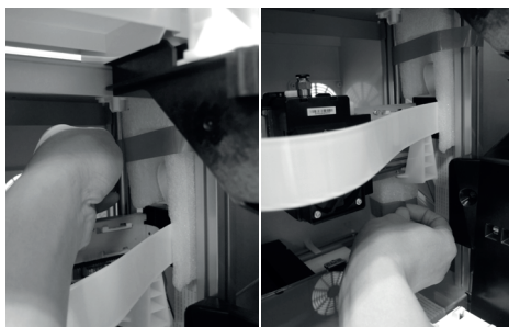
4 Upewnij się, że usunięto blokady ruchu z wszystkich osi.
