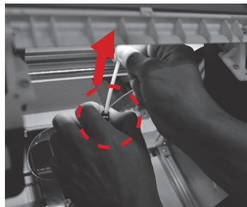
5. Ostrożnie naciśnij sprężynę wokół otworu podającego i wyjmij rękę prowadzącą filament (nie należy odłączać płaskiej taśmy kabli).
