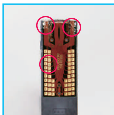
Uszkodzona głowica (pogięty przewód i wytarte pola)
